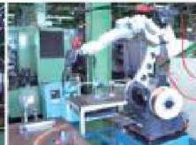
溶接ロボット
